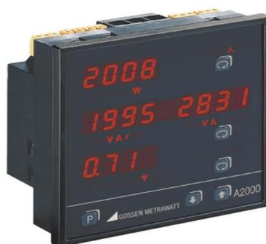
Figura 2.10 Analizador de redes trifásicas A2000.
