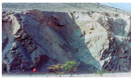
**Fotografía 2.6.** Deslizamiento en Cuña
