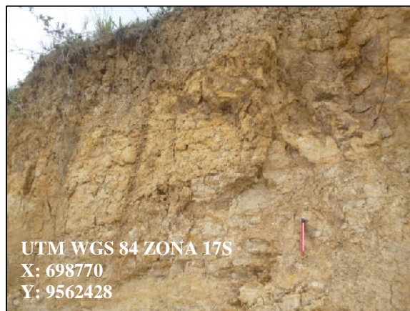
Fotografía 23. Arcillas y limos con capa de materia orgánica en la parte superior.
