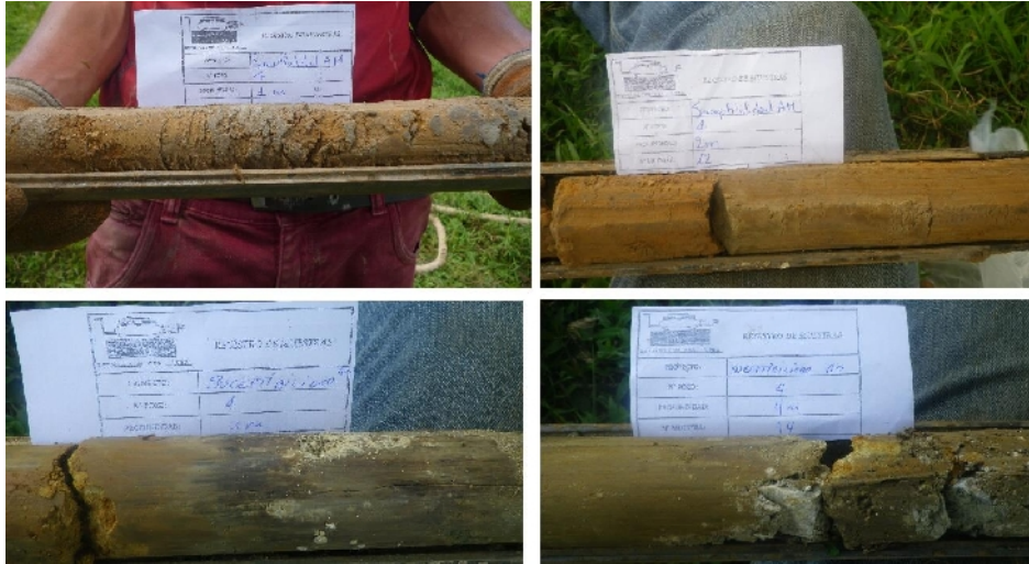
Fotografía 14. Testigos de perforación del SPT 4.
