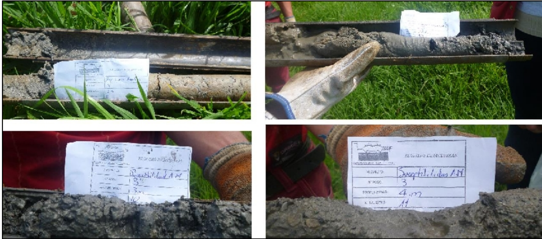
Fotografía 12. Testigos de perforación del SPT 3.
