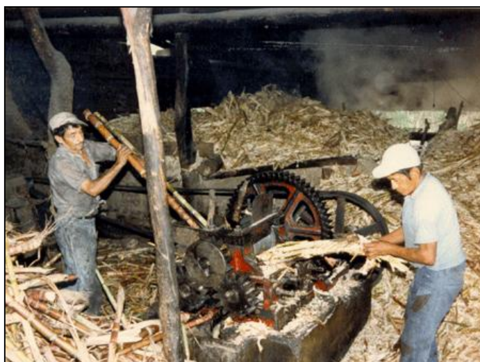
Fotografía 18. Proceso de molienda de la caña.
