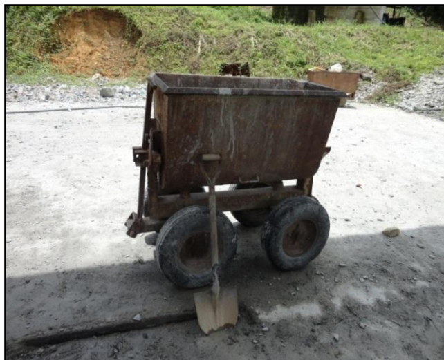
Foto N ° 11: Carrito de mina capacidad de carga 0.5 toneladas
