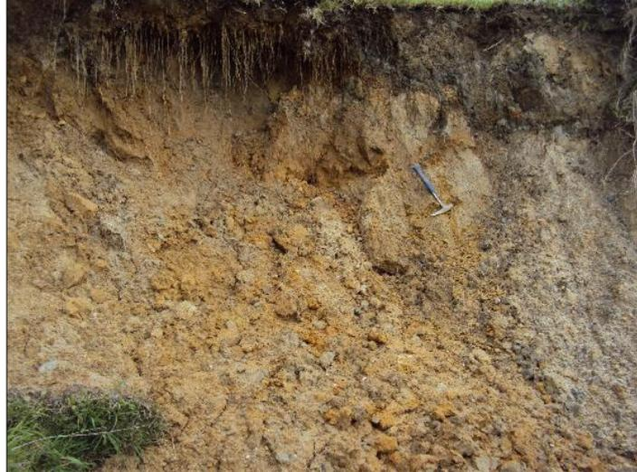
**Figura 14.** Afloramiento de arcillas limosas en el margen de la vía de Integración Barrial.
