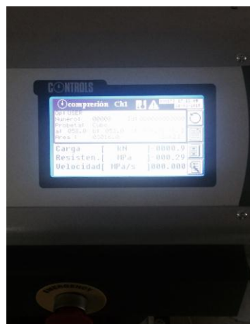
Figura 24. Marcación de carga o esfuerzo Fuente: El Autor
