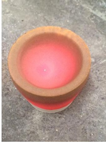
Figura 19. Metal fundido en copela Fuente: El Autor
