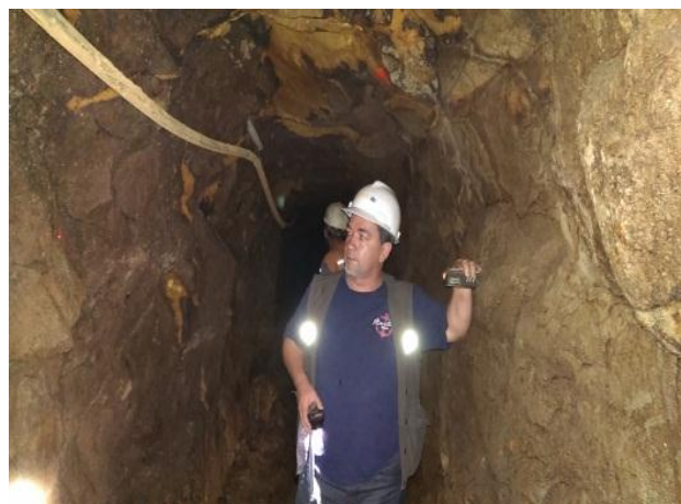
Figura 26 Midiendo con el distanciometro el ancho de la galería Fuente: el autor
