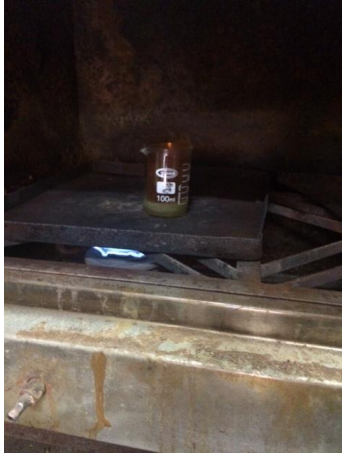
Figura 17. Ataque con ácido la muestra. Fuente: El Autor
