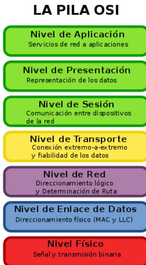
**Figura N° 8:** Modelo de la pila OSI
