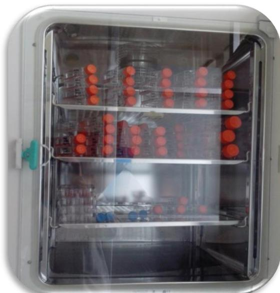
**Fig. 3** Conservación de células en incubadora de CO2 al 5% con humedad del 98%
