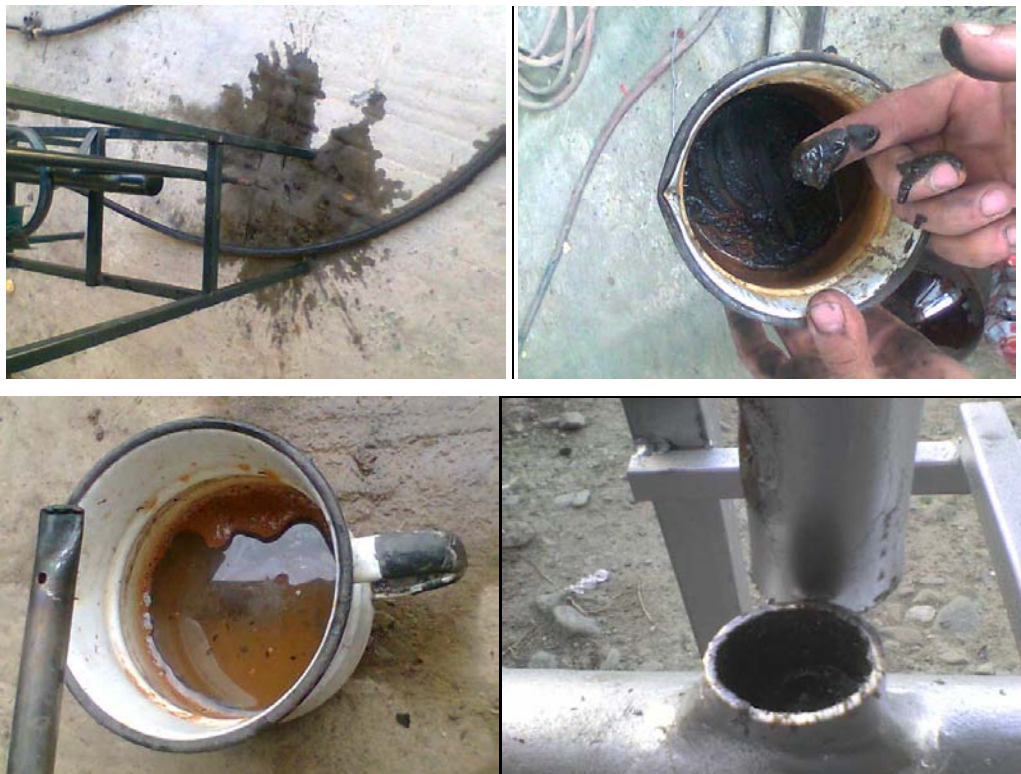
Imagen 4. Obstrucción de la cañería por impurezas.
