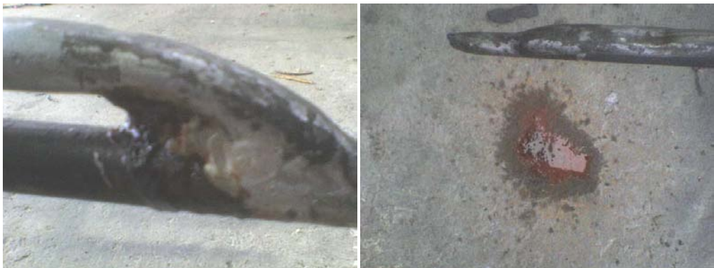
Imagen 7. Efecto de evaporación a la salida del condensador por falta de un intercambiador de gases.
