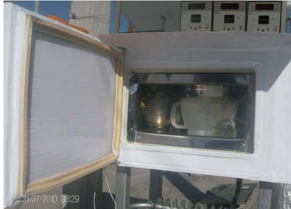
Fig. 54. Cámara de Refrigeración.
