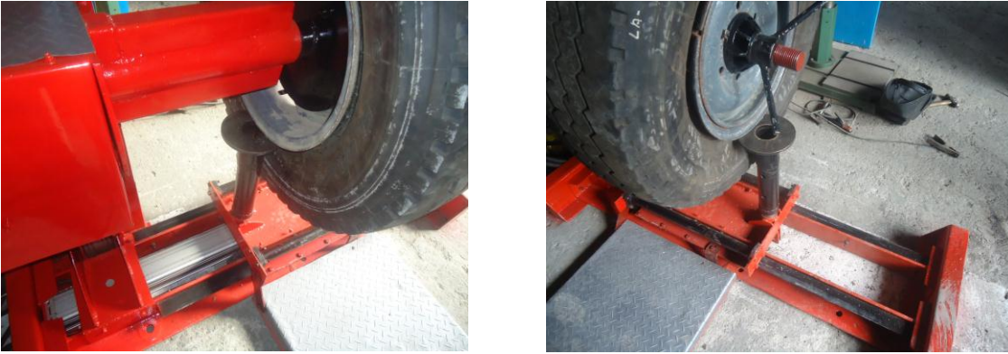
Fig. 6.2: Deslizamiento de los talones de los neumáticos.
