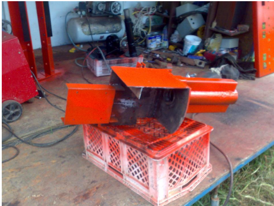
Fig. 5.22: Pintado de cuerpo de mandril.
