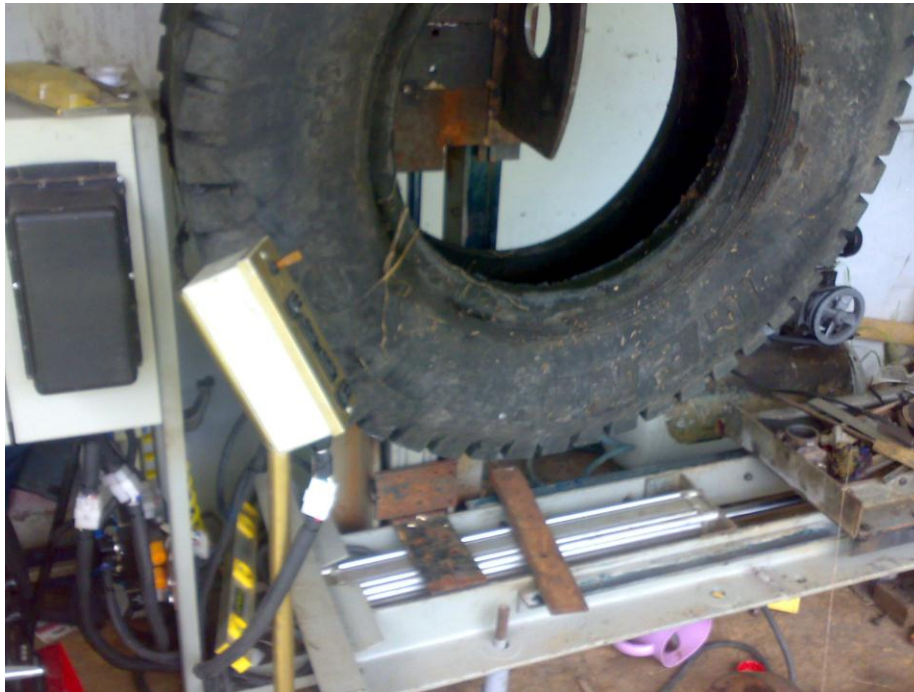
Fig. 5.6: Comprobación de accionamiento de equipo electro-neumático.
