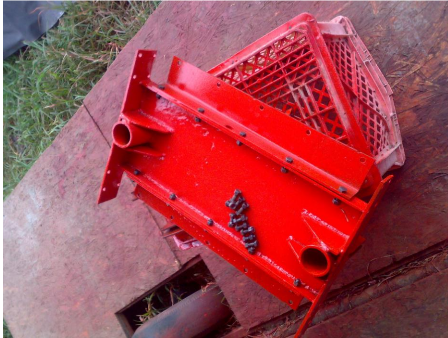
Fig. 5.21: Pintado de bancada horizontal.
