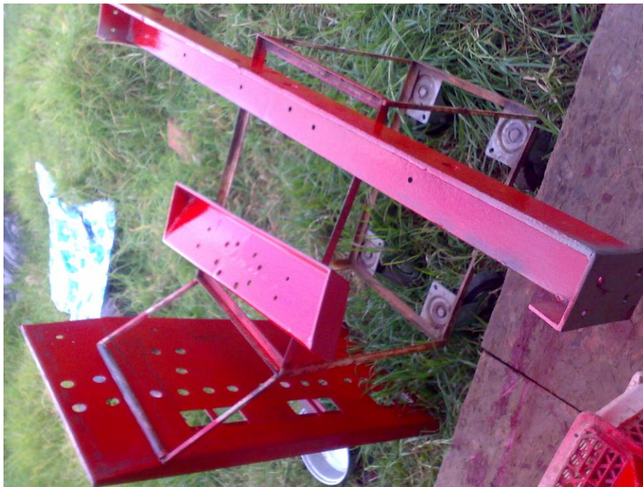
Fig. 5.20: Pintado de base horizontal y rampa.
