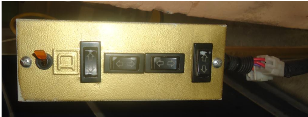
Fig. 6.4: Mandos eléctricos de pilotaje.
