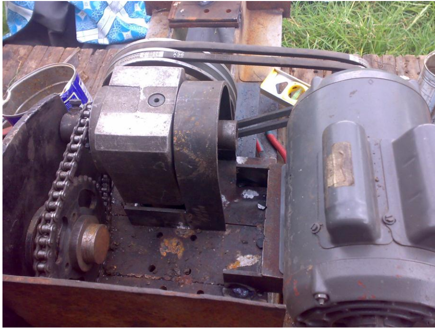
Fig. 5.15: Acoplamiento de sistema de transmisión
