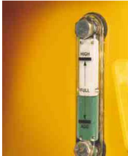
Figura 2.8 Indicador de nivel de depósito de aceite hidráulico
