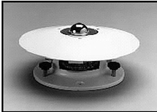
Fig. 8: Pirgeómetro Eppley
