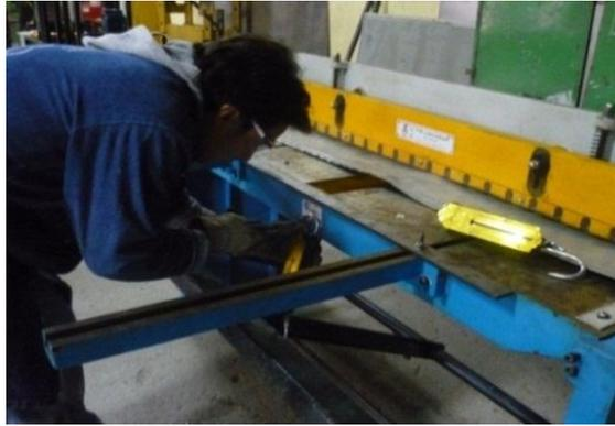
Figura 34. Ensayo para la Determinación de la Fuerza de Vacío.
