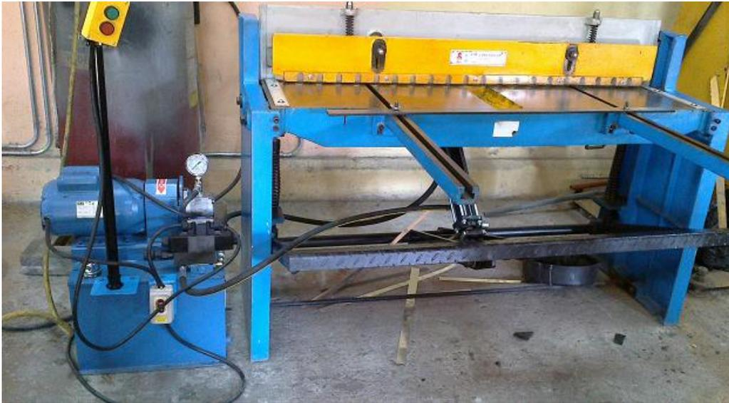
Figura 58. Cizalla Hidráulica.
