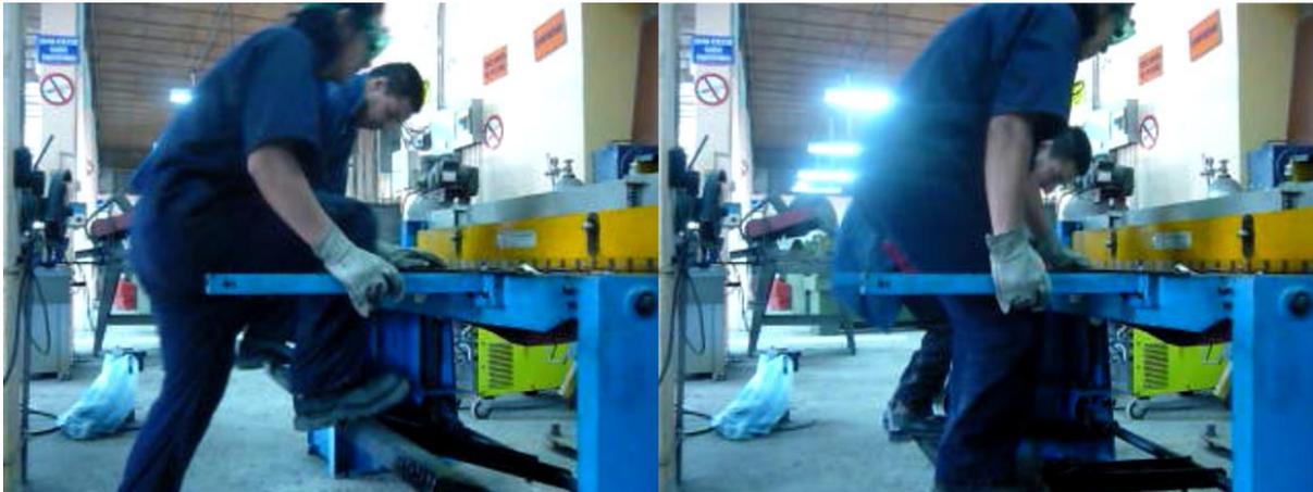
Figura 42. Operación de Corte Accionado por Pedal.
