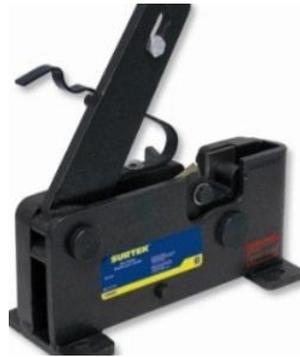
Figura 4. Cizalla de Cuchilla Corta Surtek.
