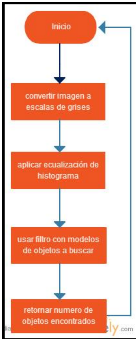
Diagrama 8: Diagrama de flujo procesamiento de la imagen.
