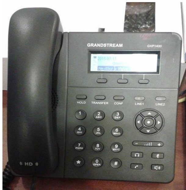
Figura 13. Teléfono ip modelo Grandstream GXP 1400
