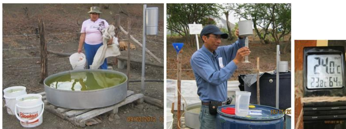
Figura 13. Tanque evaporímetro Clase A, y recipientes de evaporación, pluviómetros e higrotermómetro.
