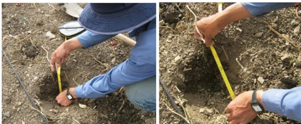
Figura 15. Medición del bulbo de humedecimiento.
