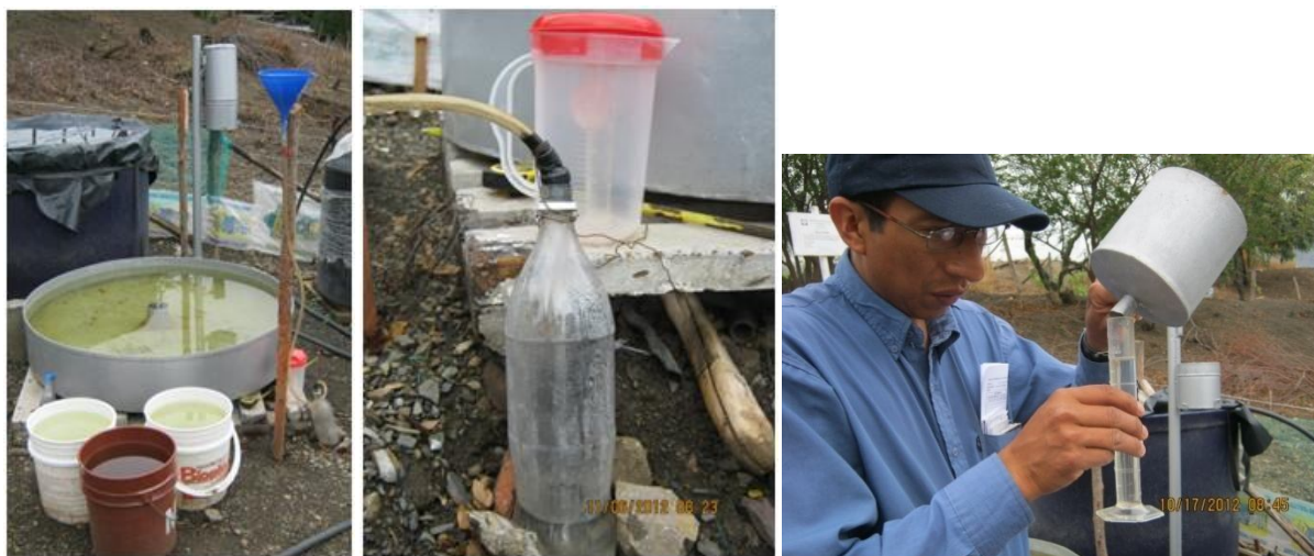
Figura 18. Implementación de un pluviómetro construido de forma artesanal
