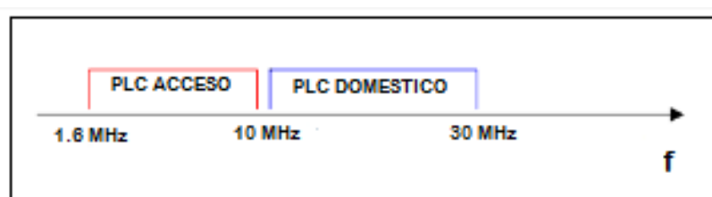
Fig. 3 Gestión de Frecuencias PCL según ETSI TS 101 867
