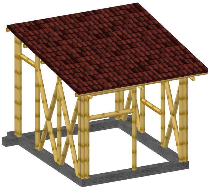
Figura 146. Ejemplo de cubierta de la cocina de la vivienda ecológica
