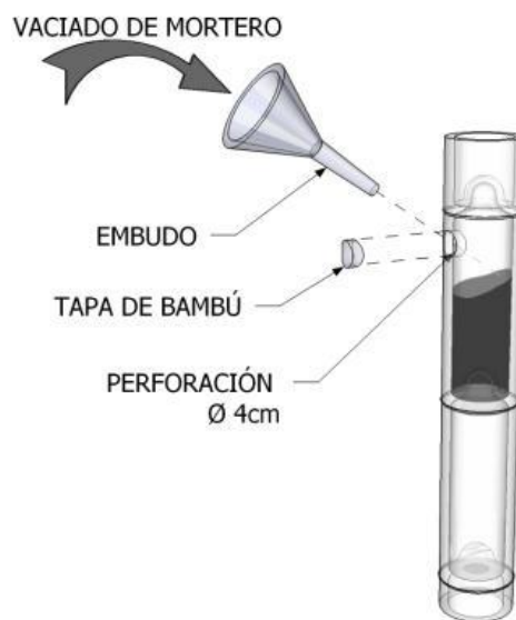
Figura 152. Vaciado de Mortero
