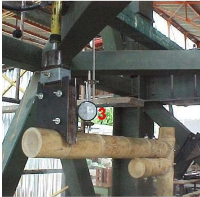
Figura 66. Dispositivo de aplicación de carga.
