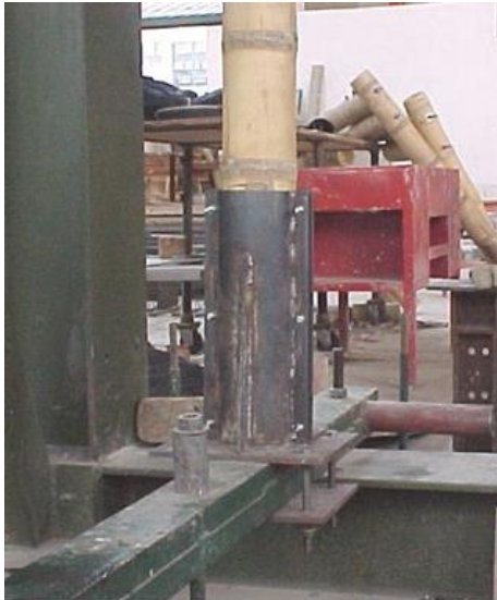
Figura 68. Detalle del mecanismo de apoyo
