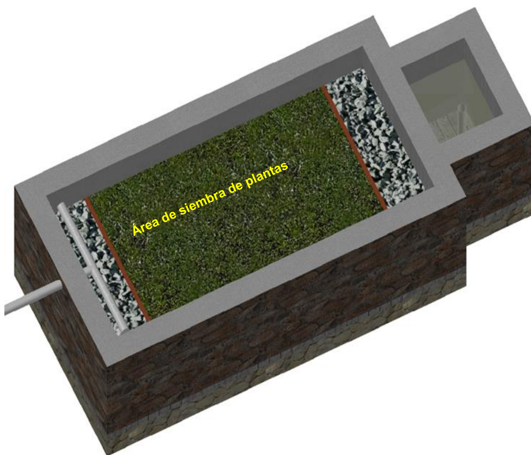
Figura 184. Colocación de plantas en el filtro
